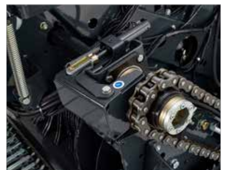
4. Hydraulisk rotorfrakobling som standard
