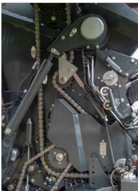
8. Robust transmission med slidstærke, stort dimensionerede kæder
