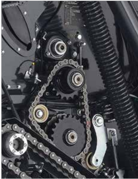
1. Ekstra kædetrukket valse garanterer et sikkert træk under alle afgrødeforhold
