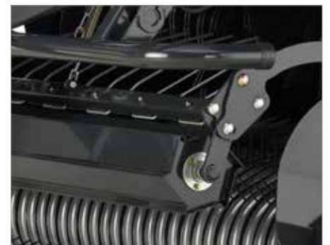
4. Kraftig afgrødevalse med afgrødestyr (Ø 217 mm)
