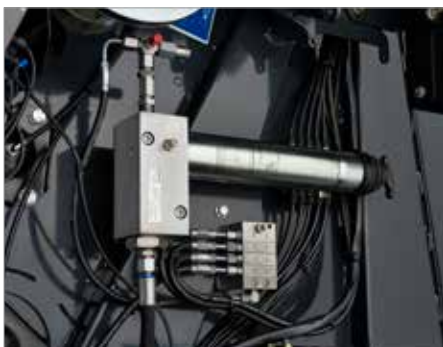
5. Automatisk smøresystem til rullelejer som standard
