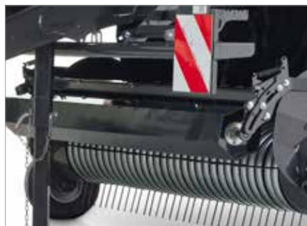
5. Kraftig afgrødevalse med afgrødestyr (Ø 217 mm)
