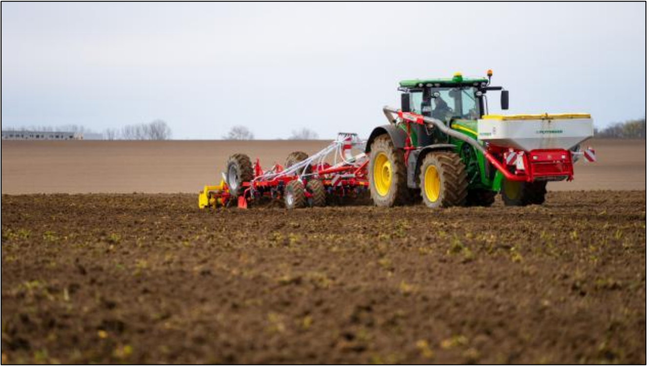
Billede 3. En Pöttinger Terria stubharve med gødningsudstyr som eksempel på nedbringning af urea uden fordampning. (foto: Pöttinger)
