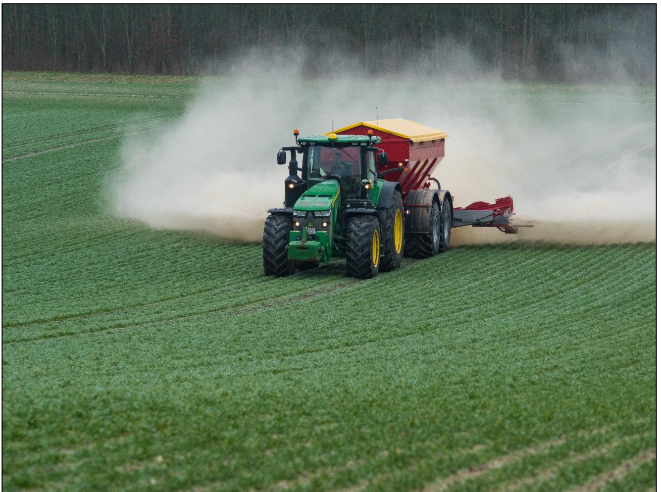
Billede 2. Bredal K-XE spreder kan sprede urea på 36 meter med det foldbare spredeværk med 2 ekstra tallerkener. (Foto: Bredal)
