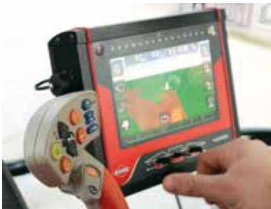
Her kan man se den nye Visioreb terminal, hvor lysdioderne sidder øverst.
