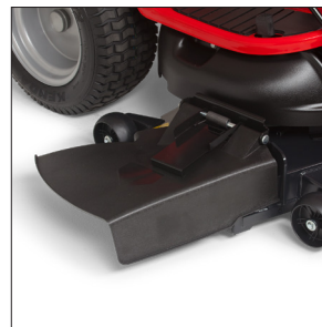
Klippebord på 122 cm Fuldsvejst og med sideudkast.
