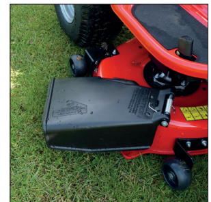
Sideudkast SPX 110 er udstyret med 107 cm klipperbord med sideudkast.
