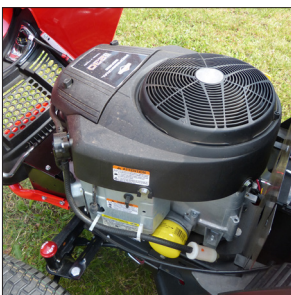
Kraftfuld motor Briggs & Stratton 2-cylindret motor som yder 23 hk.
