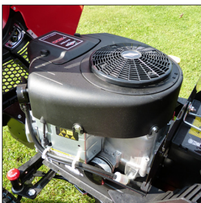
Stærk motor Briggs & Stratton 2-cylindret motor med 20 hk.
