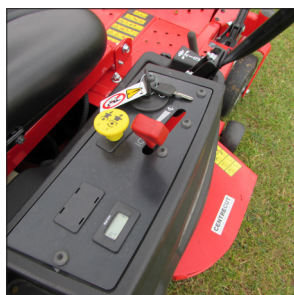
Nemt betjeningspanel Maskinen har el-starter og integreret håndbremse.
