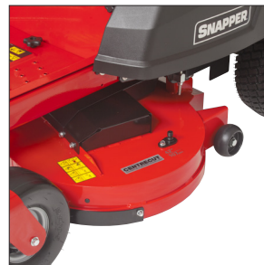
Bagudkast 107 cm klipper med bagudkast gør klipping omkring bede lettere.
