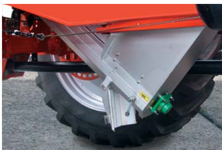
Die außenliegende, sensorüberwachte Edelstahlschnecke ermöglicht eine gute Zugänglichkeit auch bei befülltem Tank.
