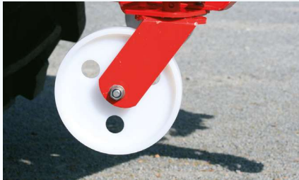
Parkeringshjul med quickmontering
