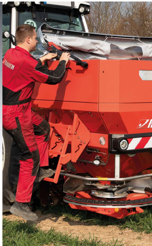
Stige med udklap og transportposition
