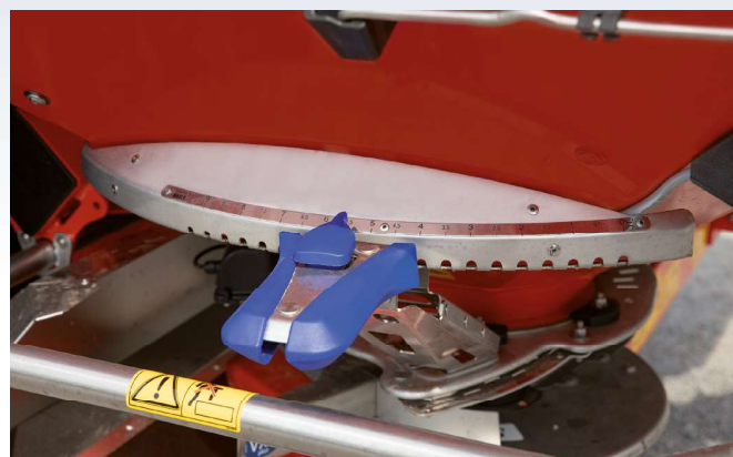
Manuel indstilling af nedfaldspunkt
