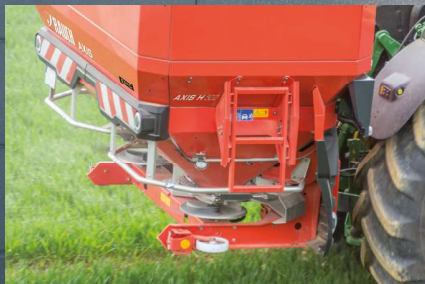
AXIS H - kantspredning i højre og venstre side med justering af omdrejningstal og nedfaldspunkt
