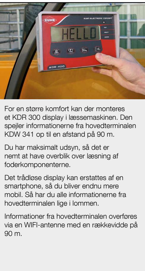
For en større komfort kan der monteres et KDR 300 display i læssemaskinen. Den spejler informationerne fra hovedterminalen KDW 341 op til en afstand på 90 m.
