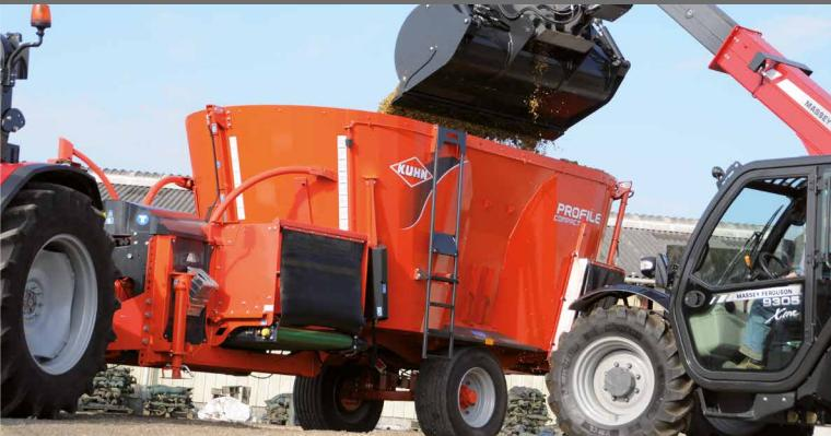
Enestående blandekvalitet ved alle størrelser! PROFILE mikservognene med to vertikale snegle begynder med 12 m<sup>3</sup> til bedrifter med krav til lav totalhøjde og går op til 20 m<sup>3</sup> til dem, der ønsker fiberrige foderblandinger.
