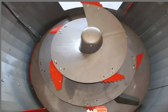
Alle sneglens dele (vindinger og midtersektion) er fremstillet af K-NOX, der beskytter hele enheden. K-NOX sneglen har en enestående modstandsdygtighed overfor friktion og syrer fra ensilagen.
