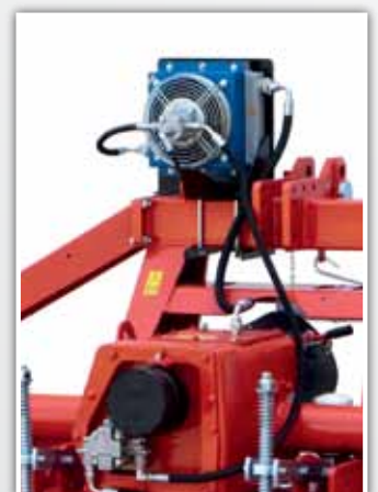
"G" modell med oljekylningssystem
