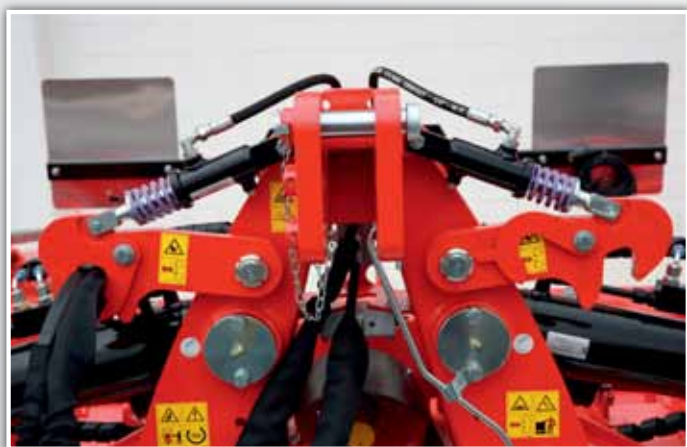
Detaljbild av ihopfällbar ram med automatisk låsning i transportposition.
