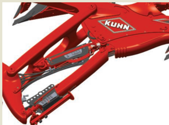
På on-land versionen kan der nemt og hurtigt skiftes mellem pløjning i furen og on-land
