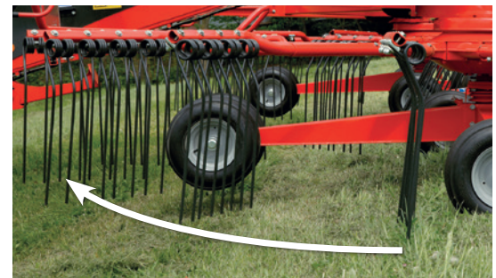
”Take off”effekten på rotorerne giver en optimal opsamling af afgrøden, så risikoen for forurening med jord minimeres. Det sker hydraulisk, samtidig med at riven hæves og sænkes.
