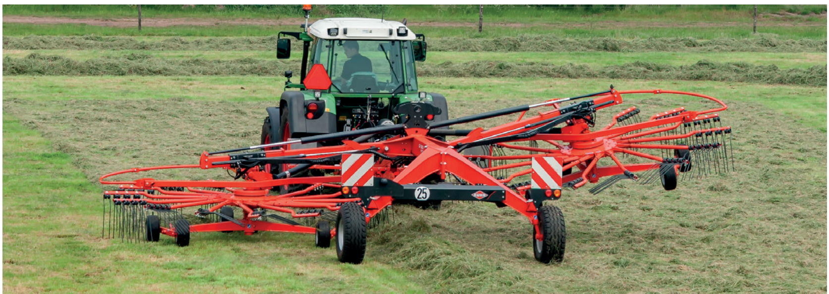
Rotorerne kan hæves og sænkes individuelt, så der kan arbejdes i kiler og på skæve foragre, eller man kan udgå at arbejde i allerede lagte skår (arkivfoto).
