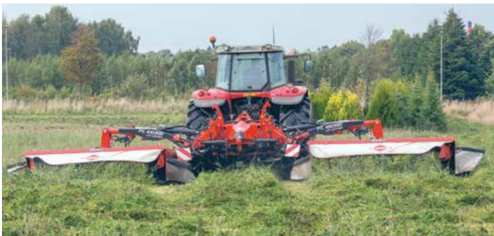
Crimperne har fingre af stål og kan indstilles til to forskellige hastigheder, så man kan vælge hvor meget, afgrøden bliver crimpet.
