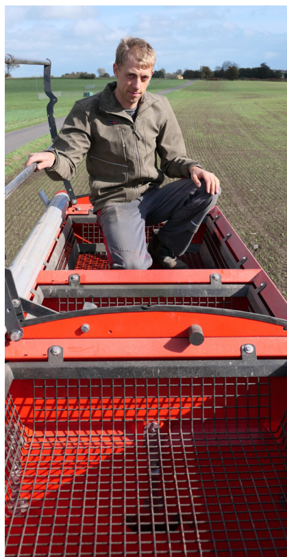
Tanken opdeles i to med lige stort indhold eller som her med 60/40 fordeling af kapaciteten, viser Karsten Ardahl Larsen.
