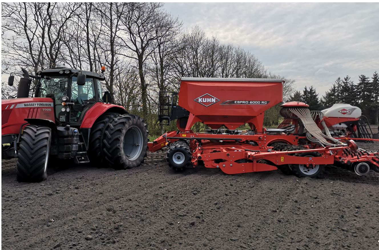
Driftsleder Christian Juhl Pedersen fremhæver Kuhn Espro 6000 RC mix maskinens præcise sådybde, uanset hvor store forskelle i jordtype, den arbejder i.
