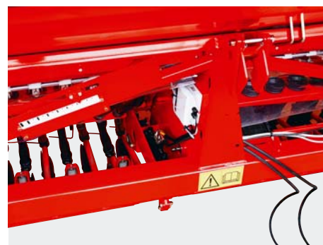
Position af det nederste anslag ved en sådybde på hhv. 8 cm og 1 cm.
