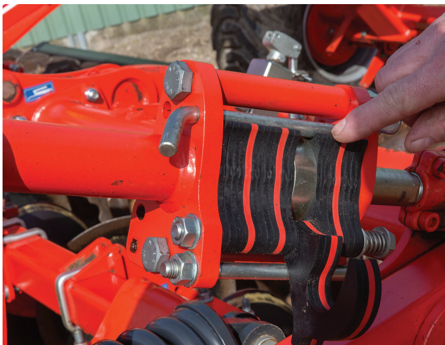
Indstilling af harvedybden sker meget nemt, præcist og hurtigt her og med en spindel ved de forreste, store bærehjul.
