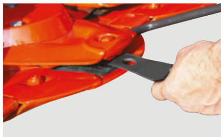
FAST-FIT montering: knive kan hurtigt udskiftes.
