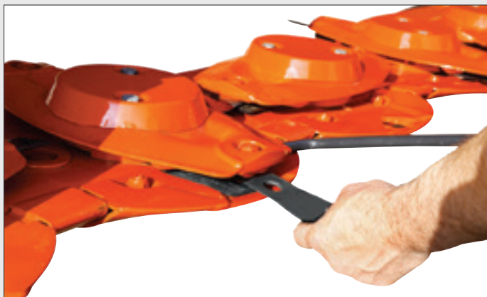
FAST-FIT monteringen: knive kan hurtigt udskiftes
